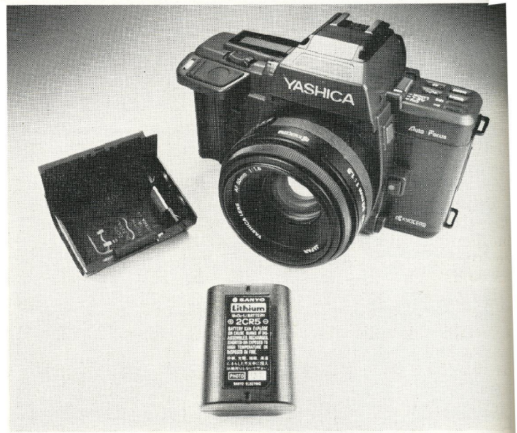
Lithium-batteriet er både kameraets styrke og svaghed. Alt fungerer hurtigt og effektivt, men alene batteriudgiften er over 18 kroner pr. 36-billeders film.
